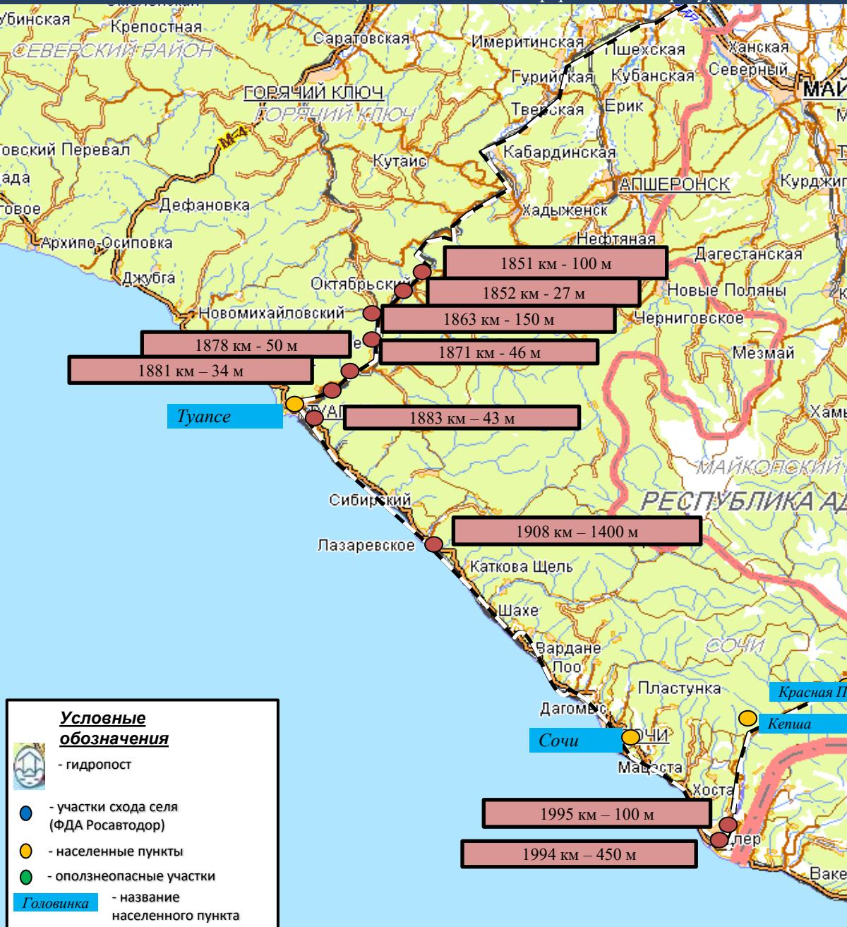
Существует вероятность возникновения происшествий, связанных с повреждением опор ЛЭП, газо-, водо-, нефтепроводов; перекрытием автомобильных и железных дорог; разрушением мостовых переходов; повреждением объектов инфраструктуры и жизнеобеспечения населения. **Источник** происшествий – обвально-осипные процессы, сход оползней, просадка грунта
